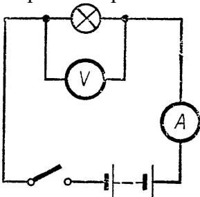
87. Отобрать приборы для измерения силы тока в электродвигателе и напряжения, под которым он работает. Начертить схему цепи, собрать эту цепь, снять показания приборов, объяснить, почему выбрали
